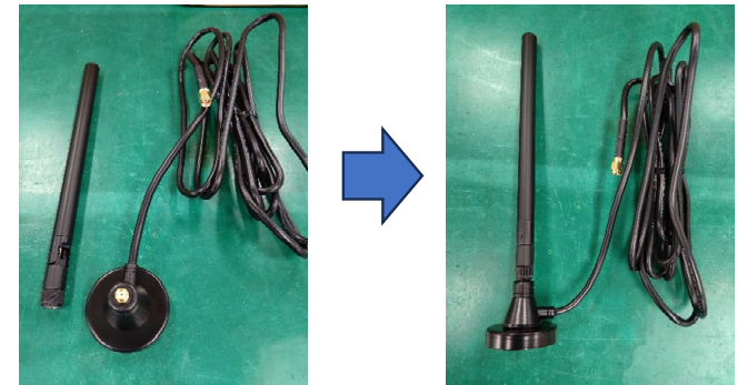
外付けロッドアンテナの組立
